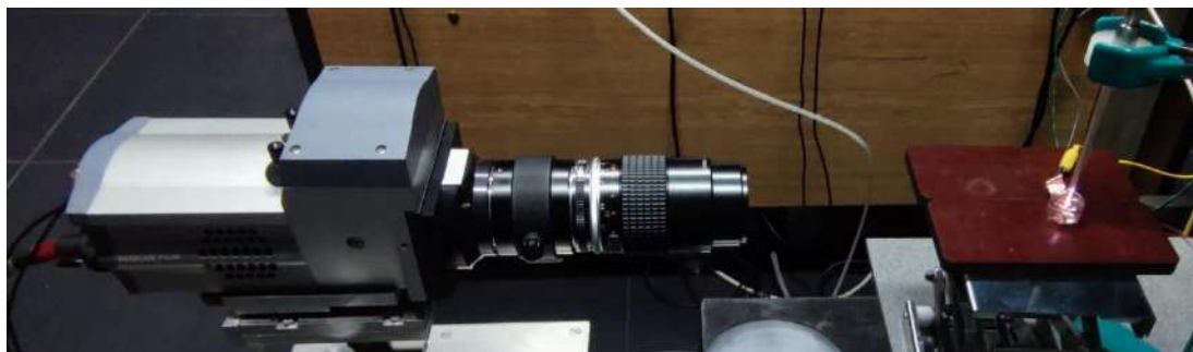
Slika 2.9: Snimanje prostornih profila pražnjenja ICCD kamerom.
