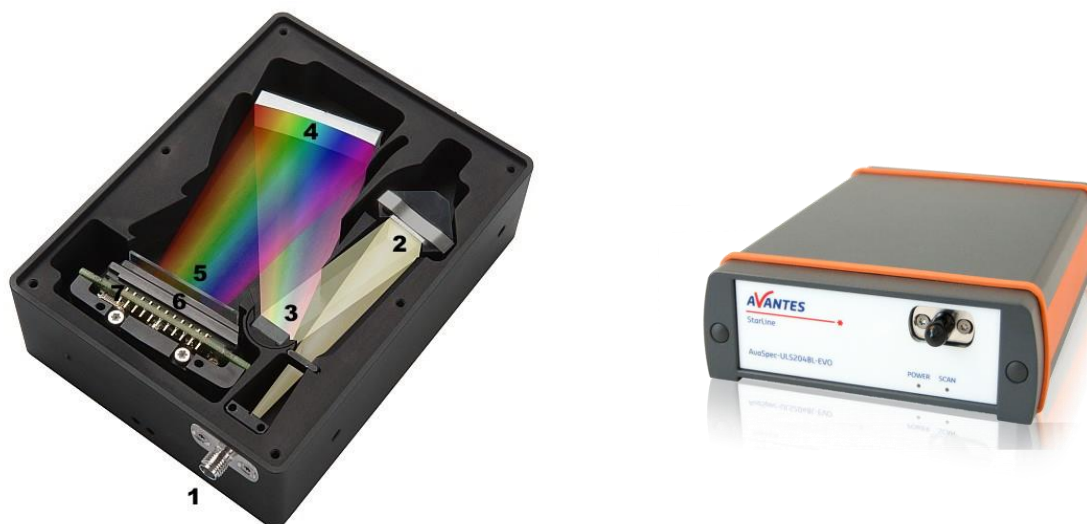
Слика 3.5. Приказ унутрашњег (а) и спољашњег изгледа (б) примењених компактних спектрометара.
