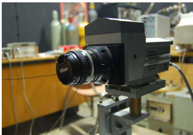
Slika 2.10 Fotografija korišćene ICCD kamere. (diplomski rad, N. Selaković 2011.)
