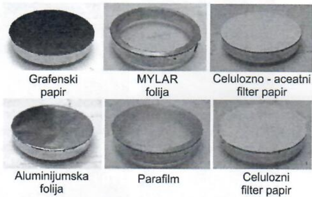
Sl. 1. Ispitivane membrane od grafenskog papira i drugih materijala.
