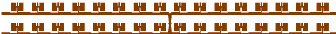
Sl. 8. Mikrostrip antena sa novim širokopojasnim patch-evima.
