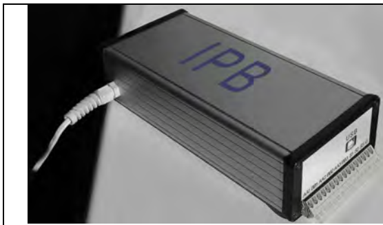
Сл. 3. Модул са напајањем, контролерима рада степ-мотора и контролером за комуникацију.
