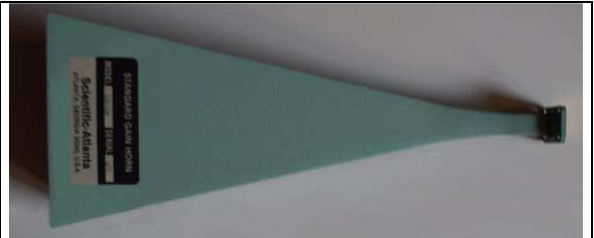
Сл. 9. Стандардна хорн антене (коришћена као референтна антена)
